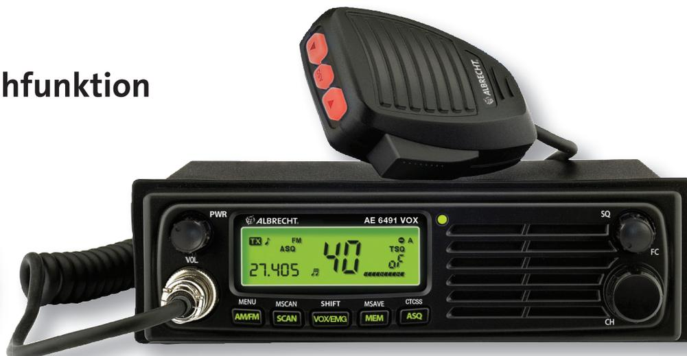
Die neue VOX Freisprechfunktion ermöglicht die Kommunikation im Fahrzeug, ohne das Mikrofon in die Hand nehmen zu müssen. Das Funkgerät erkennt, wenn der Fahrer spricht und startet automatisch die Funkübertragung. Die Empfindlichkeit und Verzögerung der VOX Freisprechfunktion kann in mehreren Stufen eingestellt werden. Somit kann das CB-Funkgerät bedenkenlos gemäß der neuesten Straßenverkehrsordnung § 23 (1a) StVO in Fahrzeugen verwendet werden.
