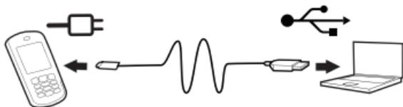
Verbinden Sie das Telefon mit einem Computer, um Bilder und Musik zu übertragen. Sie können das Telefon über ein optional erhältliches micro-USB-Kabel mit dem Computer verbinden. Anschließend können Sie im Datei-Explorer des Computers mit der Funktion „Ziehen und Ablegen“ Daten zwischen dem Telefon und dem Computer kopieren oder verschieben.
