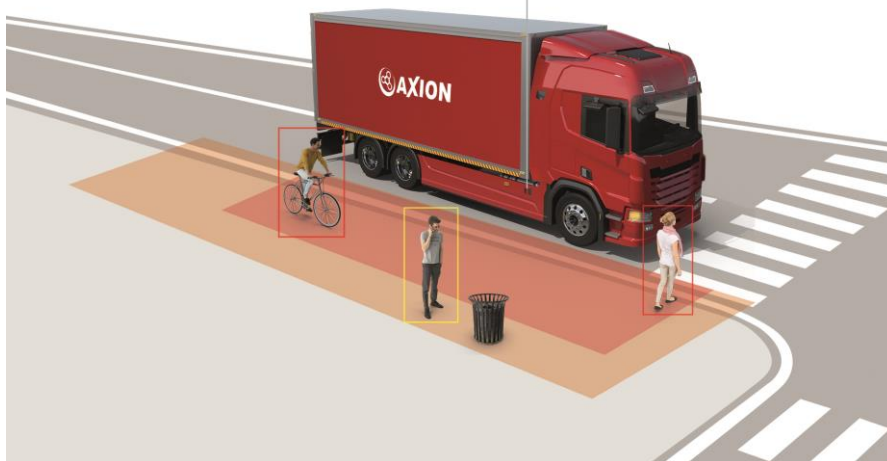
ICA Turn-Assist XR45 Radarbasierter Abbiegeassistent mit 77GHz Technologie
