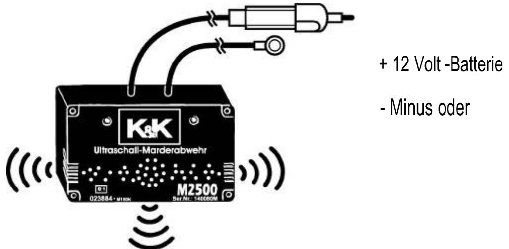
Das K & K-Ultraschallgerät wird in den Motorraum, möglichst direkt unter der Motorhaube so eingebaut, dass das Gerät nicht unmittelbar mit Schmutz- oder Spritzwasser in Berührung kommt. Es sollte so eingebaut werden, dass die vorderen und seitlichen Schallausgänge direkt in die bissgefährdeten Stellen strahlen, jedoch nicht unmittelbar an den Auspuffkrümmer oder direkt neben dem Motor - wegen zu großer Erhitzung.
