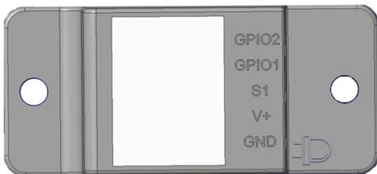
Verbinden Sie den Anschluss GPIO1 und/oder GPIO2 mit dem I/O-Kabel (Eingänge) des TomTom LINK 710 oder 510
